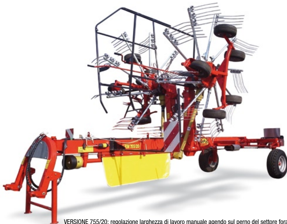
VERSIONE 755/20: regolazione larghezza di lavoro manuale agendo sul perno del settore forato.
