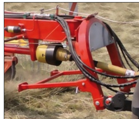
VERSIONE 755/20: regolazione larghezza di lavoro manuale agendo sul perno del settore forato.
