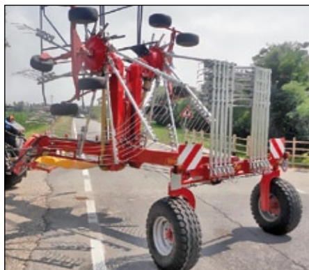
VERSIONE 755/20: regolazione larghezza di lavoro manuale agendo sul perno del settore forato.
